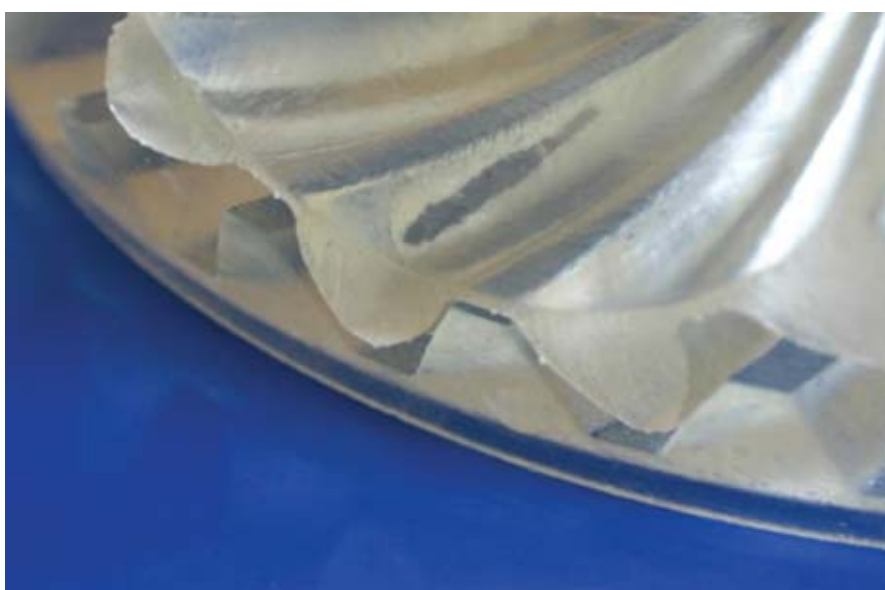
Rys. 5. Widok chwilowego śladu styku przekładni Fig. 5. Contact area visible „on internal” side of pinion
