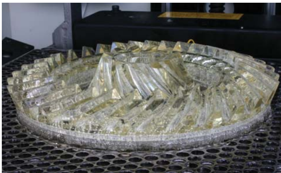
Rys. 3. Modele SLA kół przekładni stożkowej w urządzeniu SLA-250 Fig. 3. SLA gears model of bevel gears in SLA-250 apparatus
