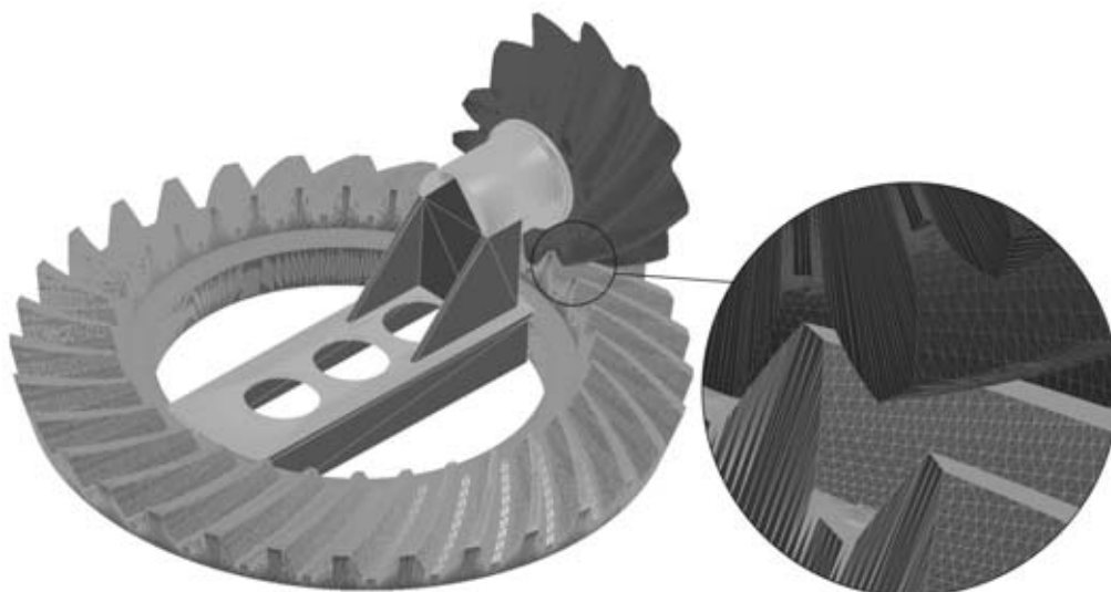
Rys. 2. Model STL przekładni stożkowej Fig. 2. Model STL of bevel gears
