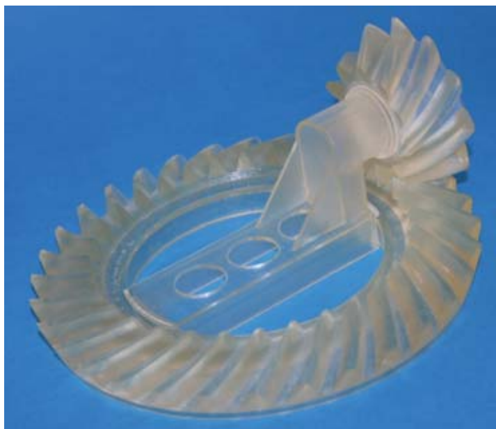
Rys. 4. Model SAL przekładni stożkowej Fig. 4. Model SLA of bevel gears
